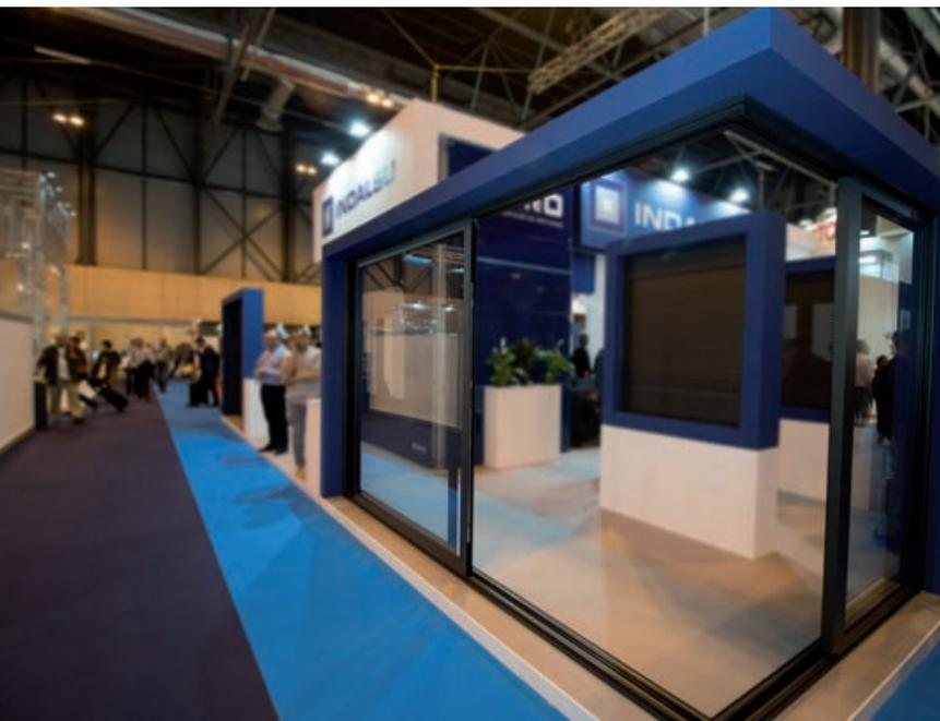
Soporta 300 kilos por hoja que se desplaza sobre un carril calibrado de acero inoxidable, instalado sobre junta de EPDM. Esto confiere al DOMO 120RT un desplazamiento suave y silencioso, y en consecuencia mayor confort.
