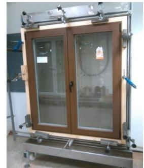
**Permeabilidad al aire****CLASE 4****Estanqueidad al agua****CLASE E<sub>1650</sub>****Resistencia a la carga de viento****CLASE C5**
